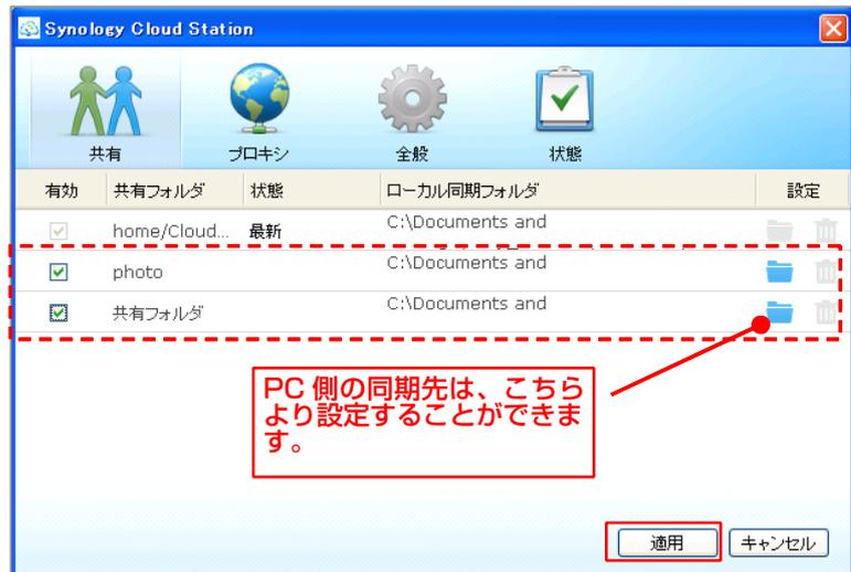
適用すると「○個のファイルをアップグレードしました。」と表示されればチェックを入れたフォルダとの同期は完了となり、同期設定したフォルダは、右図のように表示されるようになります。
